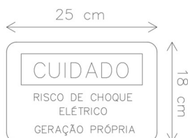
Figura 5: Placa a ser instalada no medidor
